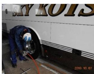
全車両のホイール・タイヤの損傷、充填エア、及び締め付けトルク状態の点検実施。
