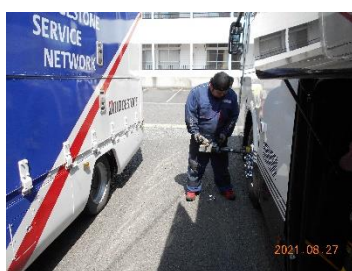
(走行時のタイヤ脱落防止の為、200Km程度の走行後を目安に増し締め点検実施)
